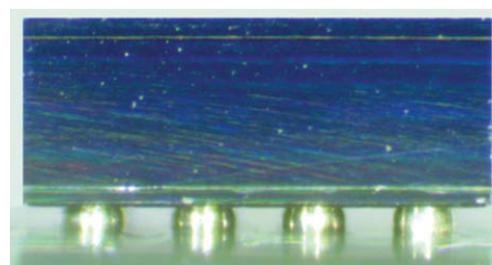
圖3：正確安裝的eGaN元件（側面視圖）。
