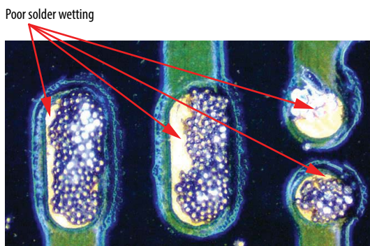
圖16: 不良焊錫熔化的例子。
