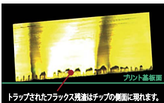
図3:傾いたチップが残留はんだフラックスをトラップ。 図4:適切に実装されたデバイス。
