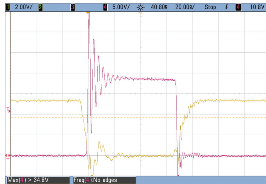
圖4:19V至1.2V/15A(1MHz)降壓轉換器的典型波形圖 通道1:低側閘極電壓 通道4:開關節點電壓
