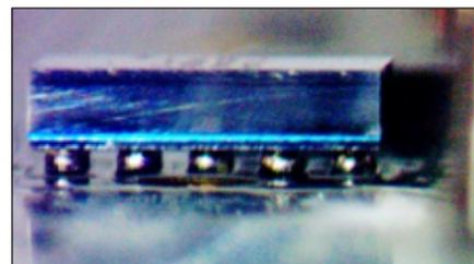
图5:正确放置的晶片,可以见到锡球有完整圆的外形,而锡球之间没有残留的助焊剂
