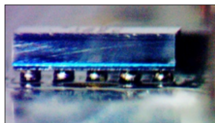
図5：バンプ間のフラックス残渣のない十分に丸みのあるバンプを示す正しく取り付けられたチップ。
