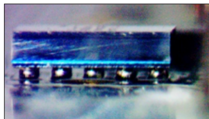
圖5: 正確放置的晶片，可以見到錫球有完整圓的外形，而錫球之間沒有殘留的助焊劑。
