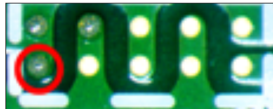
圖2: 把焊料預敷在焊盤上的正確方法。
