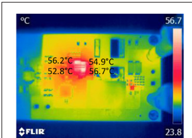
図7: 出力電流12.5 A、強制空冷800 LFMの熱定常状態における3レベル・バック・コンバータの熱画像
