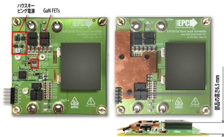
図4. 56 V入力、20 V出力で、250 Wの同期整流型バック・コンバータEPC9153のヒートスプレッドのない写真(左図)と、ヒートスプレッドを取り付けた写真(右図)
