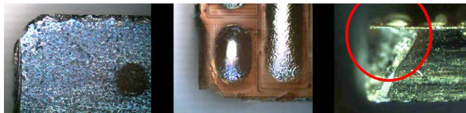
図4b: 上の図に示されている視認除外部品: 角にかなりの欠けがある部品EPC1001。裏面の欠けが欠けを通して広がっています。チップは、まだアプリケーションで機能していました。プリント回路基板からの取り外した後のチップが示されています。
