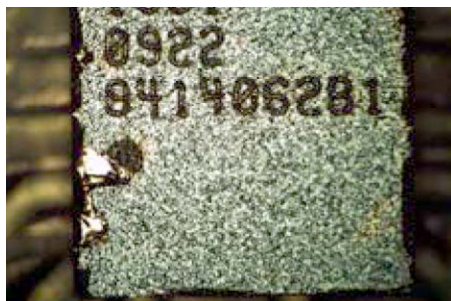
図4c: 部品EPC1001 (上) は、 -40^{\circ}\text{C} から 125^{\circ}\text{C} の間で1000サイクルのTC (温度サイクル) 試験に合格しました。チップ幅は約 1900\text{ }\mu\text{m} 。裏面の欠けは 250\text{ }\mu\text{m} 以上です。
