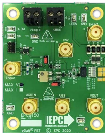
EPC9150 長距離Lidar 221 A レーザー・パルスのピーク 2.9 ns幅のパルス
