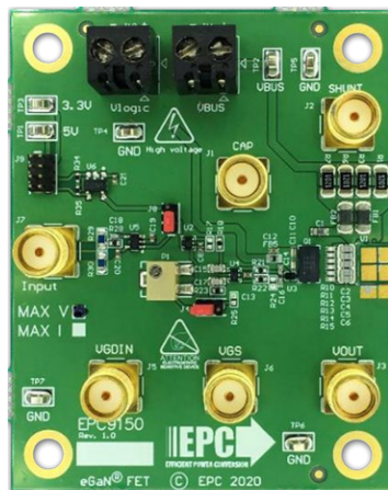
EPC9150 长距离激光雷达 221 A 激光脉冲峰值 2.9 纳秒宽脉冲
