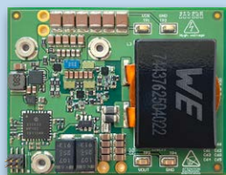
EPC9148: 48 V入力、19 V出力の超薄型マルチレベル・コンバータ
