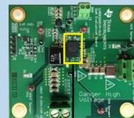
米テキサス・インスツルメンツのリファレンス・ボード設計 (PMP4435) : 48 V入力で300 WのeGaN FET搭載1/8ブリック・デジタル・モジュール
