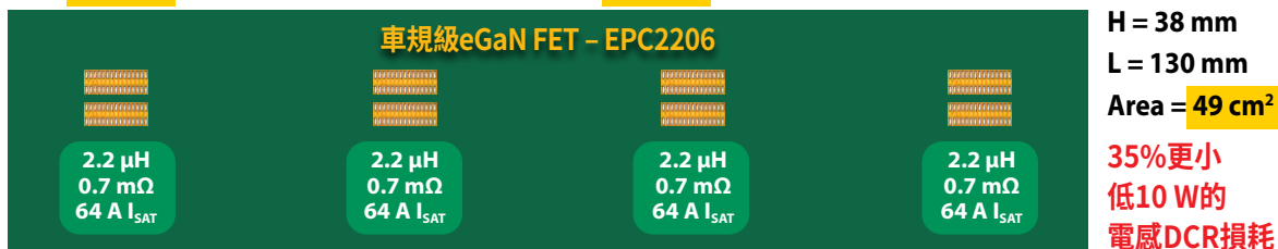
圖 2. 在48 V/12 V、3 kW系統中，基於eGaN FET與硅MOSFET的解決方案的尺寸比較
