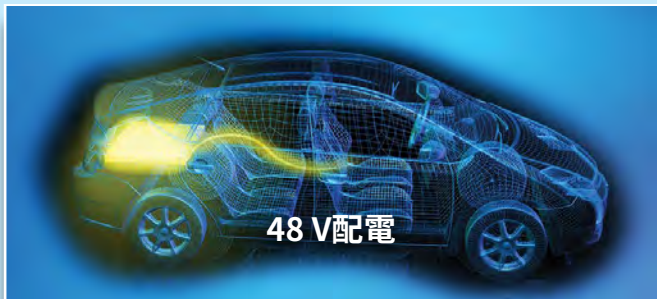
用於輕度混合動力車的48 V輸入/12 V輸出
