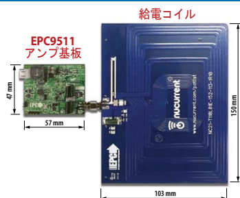
EPC9121: 10 W マルチモードのワイヤレス・パワー充電用eGaN FETとIC の評価キット
