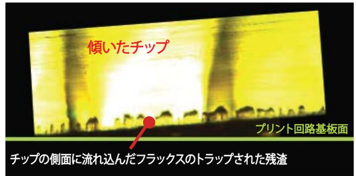
図19: はんだ付け後、かなり傾いたeGaNデバイスのチップの側面図。
