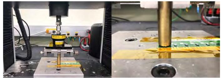
図17: 圧力試験装置。テスターのヘッドは、ゲージによって所定の力が感知されるまで、0.6 mm/分の一定のローディング速度でデバイスの背面まで下がります。DUT (被測定デバイス) は、試験台上に固定されているFR4テスト・クーボンに表面実装します。
