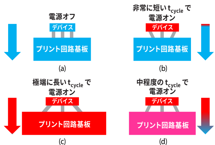
図4-50: はんだ付けによって観測される熱機械的歪みの比較。条件 (a) : 電力が供給されていないため、デバイスとプリント回路基板は両方とも青色です; 条件 (b) : 非常に短い t_{Cycle} でデバイスの電源が投入され、デバイスは高温 (赤色) ですが、プリント回路基板は周囲温度 (青色) のままです; 条件 (c) 非常に長い t_{Cycle} でデバイスの電源が投入され、デバイスとプリント回路基板は両方とも T_{Max} に達します (両方とも赤色); 条件 (d) 中程度の t_{Cycle} でデバイスの電源が投入され、デバイスは高温 (赤色) ですが、プリント回路基板は中間温度 (ピンク色) にしか達しません。
