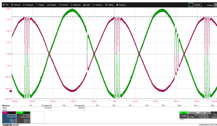
図4. 相電流と電流検出信号。電圧のしきい値は正ですが、シャント抵抗のケルビン接続によって、負の電流値で過電流回路がアクティブになることに注意してください。カーソルで測定すると、過電流のしきい値は-32 Aに設定されています。
